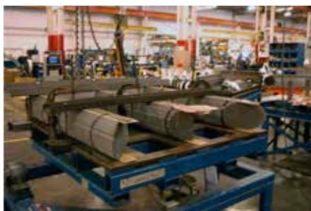
Step-Lap Mitre Core Construction
